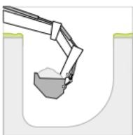
Am künftigen Maststandort wird ein Schacht ausgehoben – je nach Gelände mittels Bagger, Presslufthammer oder bergmännisch.
